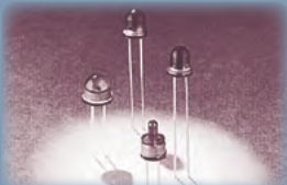
開発当時の赤色 LED ランプ (1976 年) At the time of development of red light emitting diode (1976)
